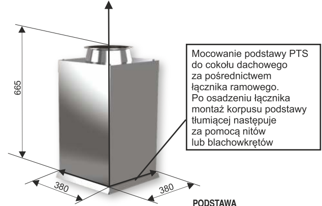
PODSTAWA TŁUMIĄCA PTS-160 masa 16 [kg]
